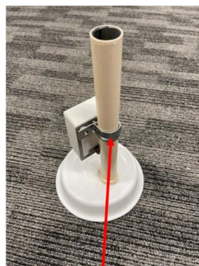
片サドルをボールに取り付 け、LAS-603V2をマグ ネットで固定する
