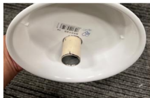
内筒の穴の位置に合わせて ボールを差し込む穴を開ける
