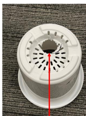
ドリルで開けた穴同士 の間をカットし、ポール 用の穴をくり抜く
