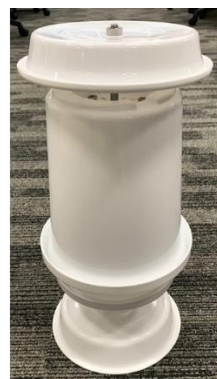
傘を取り付けた日よ けを差し込んで完成
